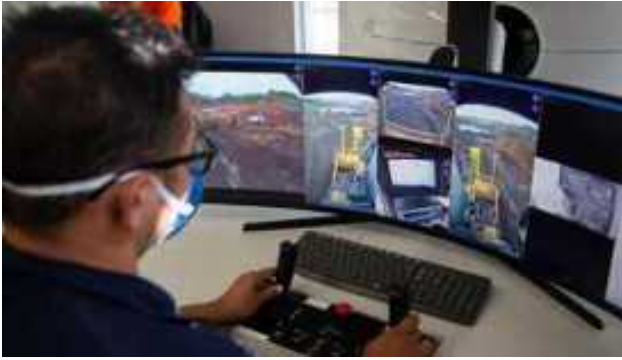
Operador de equipamento remoto (usado na descaracterização da B3/B4) no Centro de Operações Remotas em BH
