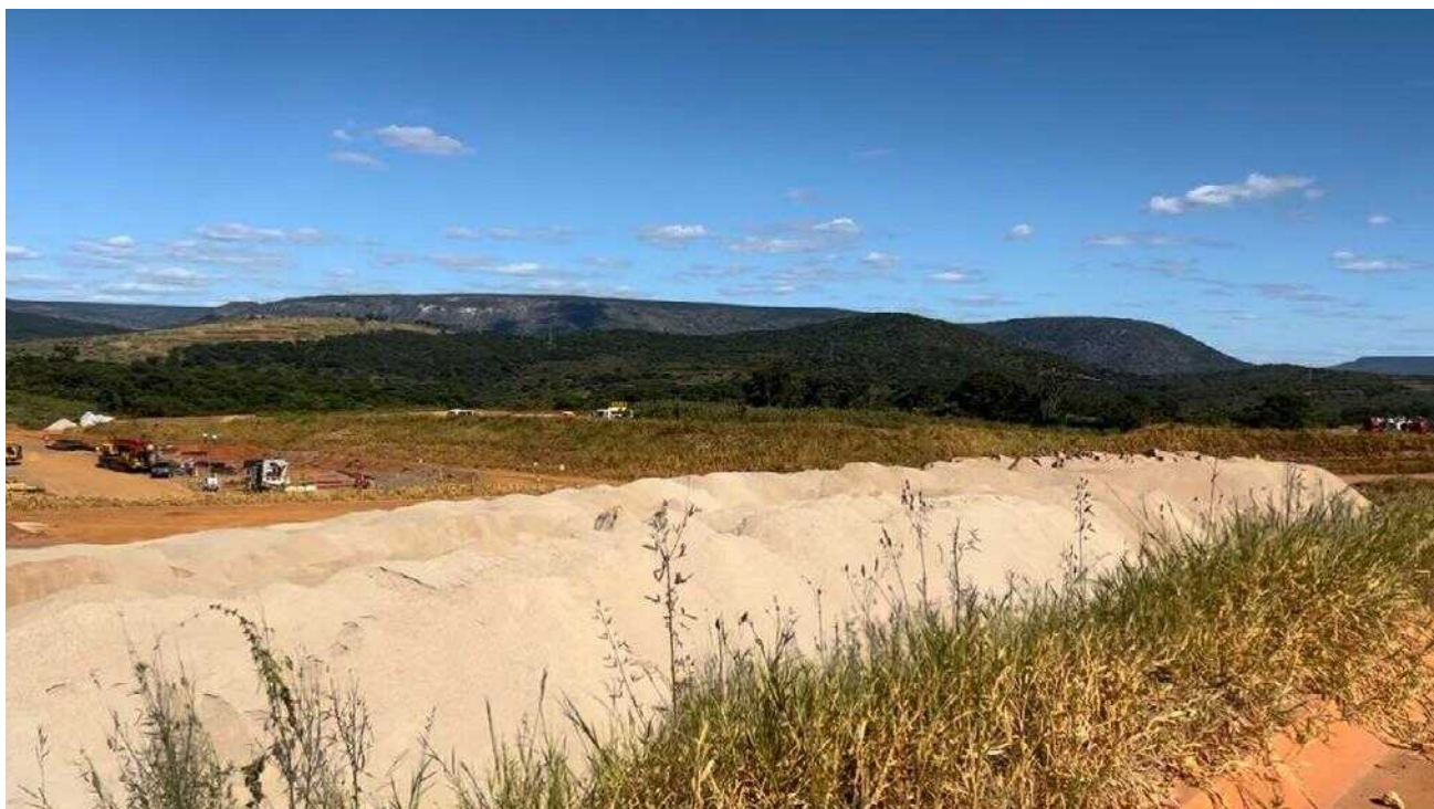
Todo o rejeito é secado. Não há barragem de rejeito
