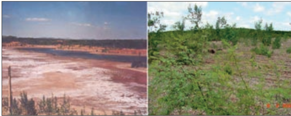
Imagens "antes (1997)" e "depois (2002)" da reconformação e revegetação no Lago de Rejeito de Maria Preta
